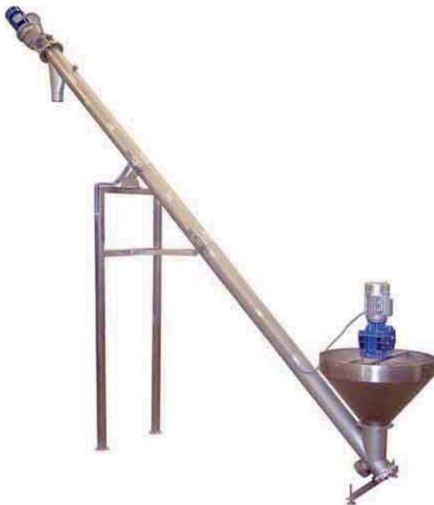
El elevador Sinfín está especialmente diseñado para alimentar a la máquina envasadora con todo tipo de productos en polvo.
