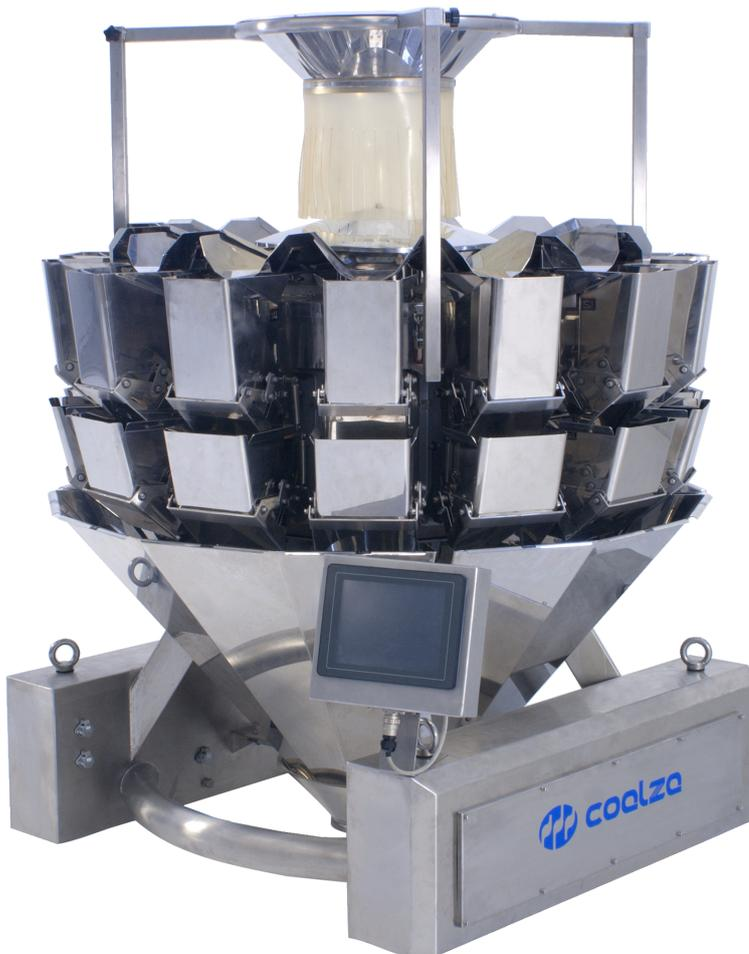
Los multicabezales Coalza Modelo M14-GT, están diseñados para obtener dosificaciones a gran velocidad y un peso exacto mediante la combinación de datos de pesadas de sus catorce boles.
