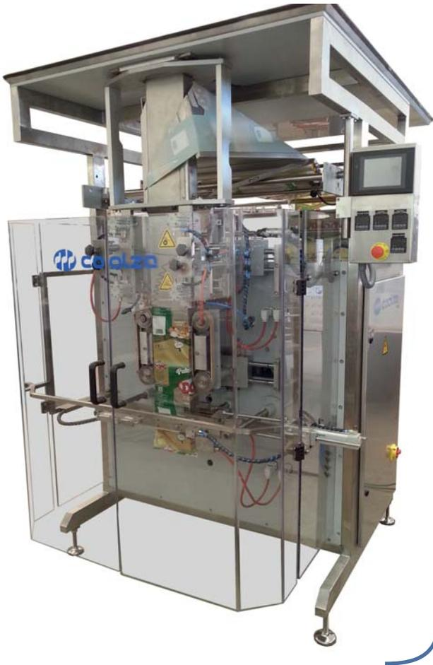
La serie RS de Coalza se caracteriza por su robustez y fiabilidad, así como por su facilidad de manejo y configuración a través de su pantalla táctil. El control de la soldadura por servomotor otorga mayor flexibilidad y velocidad de producción.
