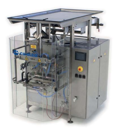
La serie RS de envasadoras Coalza se caracteriza por su robustez y fiabilidad, así como por su facilidad de uso y configuración por pantalla táctil. La soldadura horizontal accionada por servomotor otorga una mayor flexibilidad y velocidad de producción.
